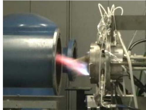
(d) Deflagration of hydrogen/oxygen mixture.
