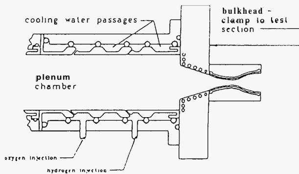
Fig. 20. Modified plenum chamber
